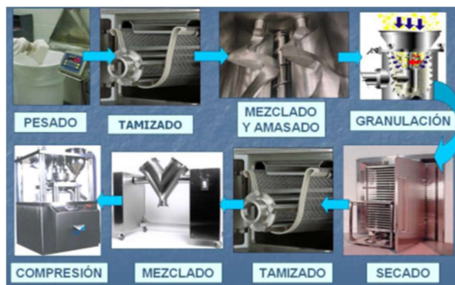
Figura 7. Proceso de compresión por granulación por vía húmeda.
